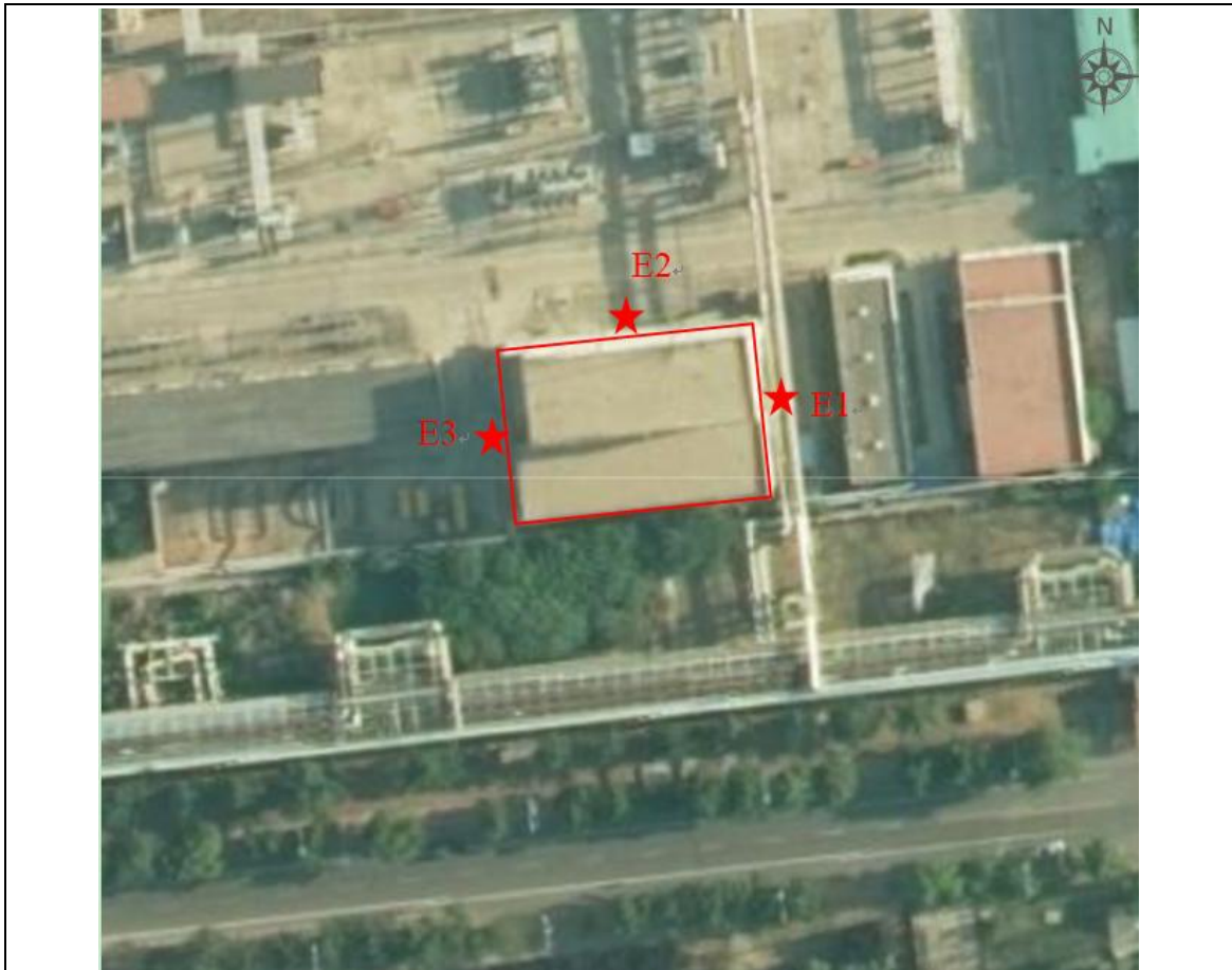
图 13 现有 110kV II 配电装置工频电场、磁感应强度监测布点示意图
